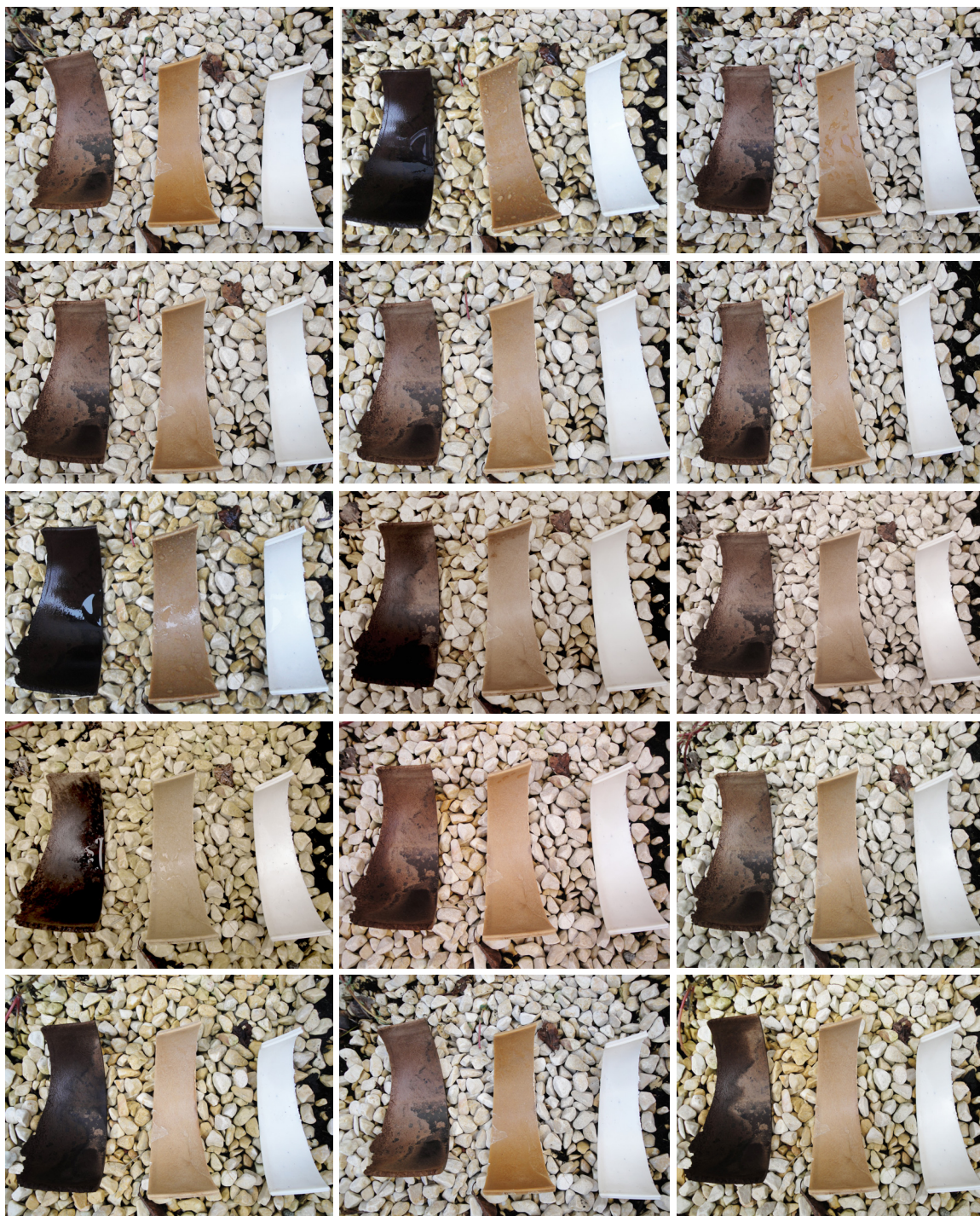
Figura 6.8 Foto dei campioni posti all'esterno, scattate per un periodo di 60 giorni.
