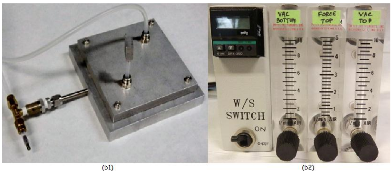
Figura 4.7 Camera di bonding (b1) e il modulo di comando (b2) della bonder costruita per l'incollaggio dei singoli dispositivi. Le dimensioni della camera sono state progettate per l'incollaggio di wafer 4".
