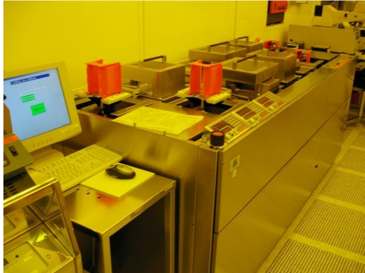
Figura 4.12 Spin Coater automatico in grado di caricare 25 wafer da 4" alla volta. Esso ha due linee di lavoro e ognuna ha sia la linea di coating sia di developing utilizzabili separatamente.
