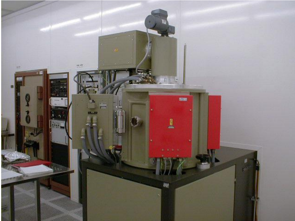
Figura 4.11 Il BAS450 è la macchina di sputtering usata per la deposizione di titanio, oro, alluminio e ossido di silicio.
