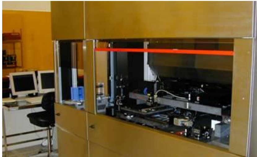
Figura 4.14 Maskless DWL 2000 della Heidelberg, usata per la produzione delle maschere.
