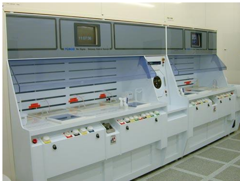
Figura 4.16 Cappa chimica predisposta al wet etching. Tra gli acidi disponibili sono presenti: il BHF 7:1, per l'attacco dell'ossido di silicio, e l'ANP per l'attacco dell'alluminio.
