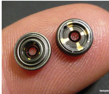
Figura 1.4 Lente Varioptic® OIS: un design electrowetting multielettrodo permette la traslazione laterale della lente ai fini della stabilizzazione ottica dell'immagine.
