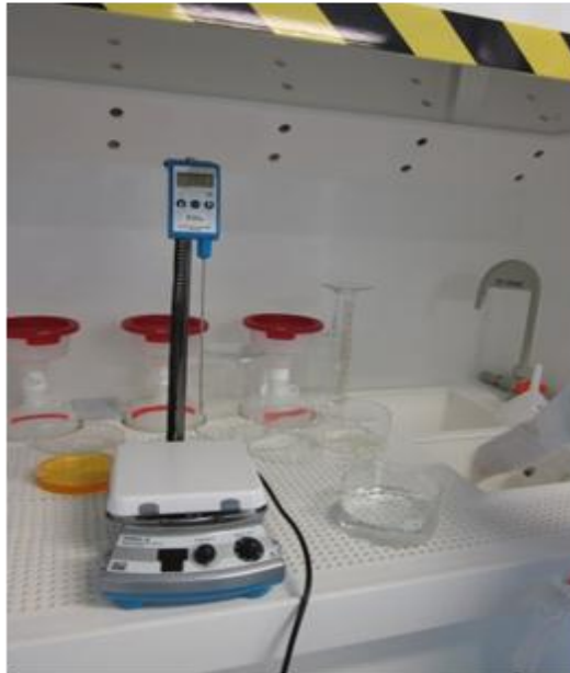
Figura 4.15 Setup usato per il wet etching dell'oro. Sono visibili: un hotplate fornito di controllo di temperatura e alcuni recipienti tra cui quello contenente la miscela di acidi.
