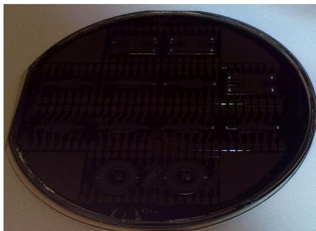
Figura 7.10 Dispositivi su wafer 4" con elettrodi in alluminio e "TOP" in silicio.
