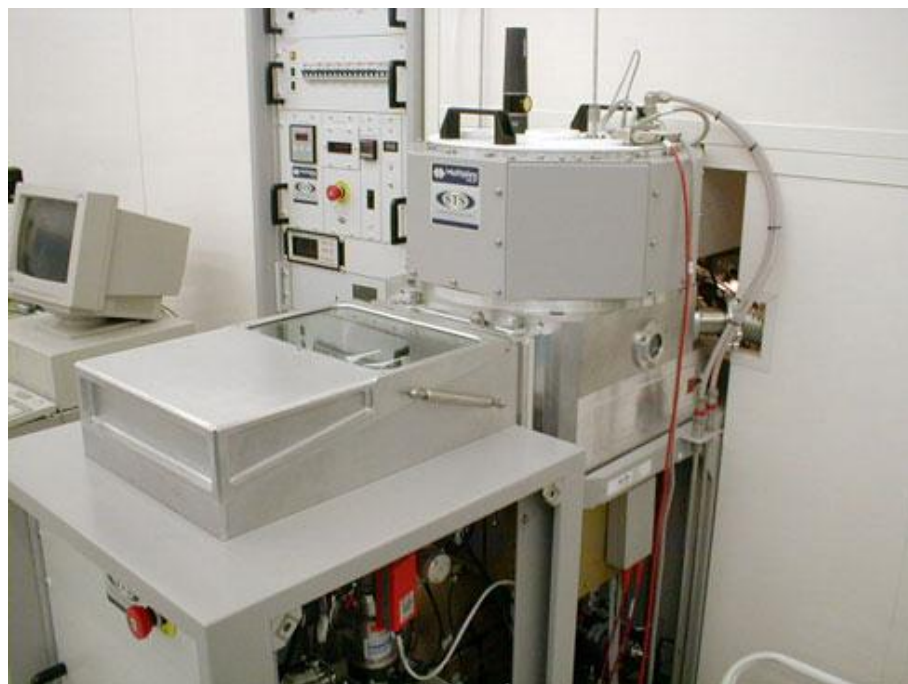
Figura 4.18 STS Multiplex ICP, in grado di eseguire l'attacco Bosch de silicio.
