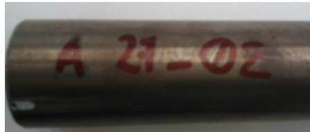
Figura 10. 4: Marcatura dei tubi.
