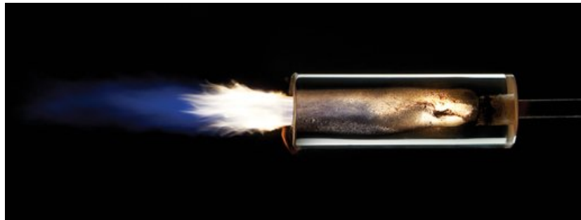
Figura 3.1: Fiamma set-up sperimentale ibrido Plexiglass/ GOx . Da notare il regime fortemente turbolento nel porto centrale
