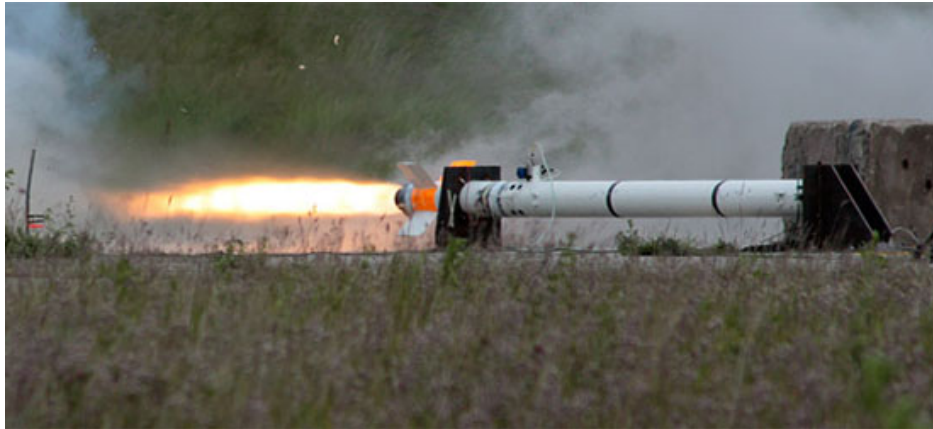
Figura 2.3: HATV Endoreattore ibrido della Copenhagen Suborbitals, con 220 mm diametro produce una spinta 12 kN
