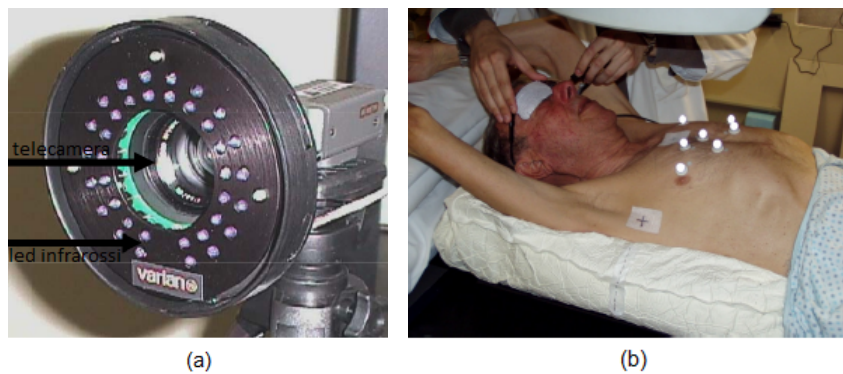
Figura 1.12: (a) Telecamera ad infrarossi usata per rilevare il movimento dei marker. (b) Marcatori passivi posizionati sulla superficie del soggetto.
