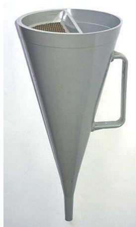
Figura 3.14 Vista di un Marsh Funnel in cui si può notare la presenza di una griglia nella parte superiore dello strumento
