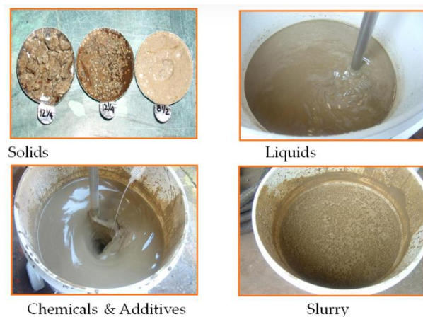
Figura 3.1 Immagini relative ai diversi componenti presenti in un tipico slurry utilizzato in un processo di Cuttings Re-Injection
