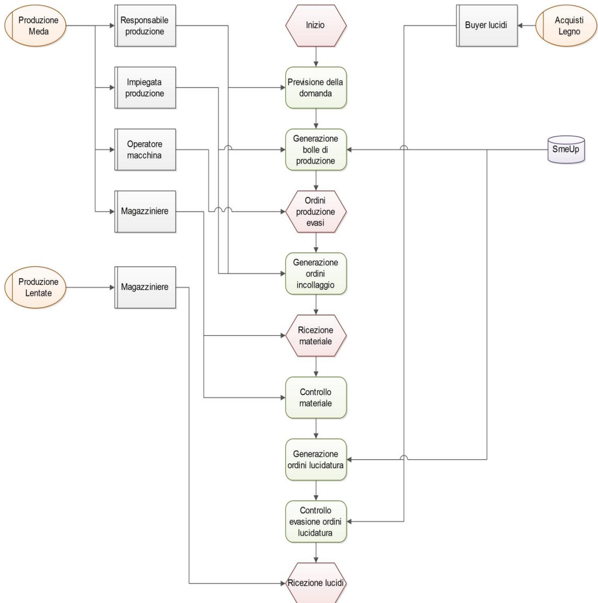
Figura 24: Processo produzione interna semi-lavorati
