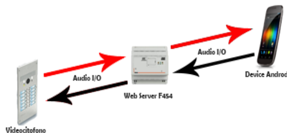
Figura 125: schema semplificato per lo scambio audio
