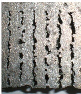
Figura 4. 18 Esiti per tagli senza abrasivo, pannelli 10 mm, velocità 5, 10, 20 mm/min
