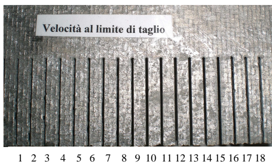
Figura 4. 20 Esito provino tagli preliminari, 30 mm, fronte
