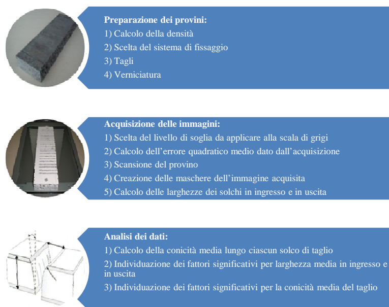
Figura 6.7 Fasi sperimentali e di rielaborazione dei dati per l'analisi della qualità del solco di taglio
