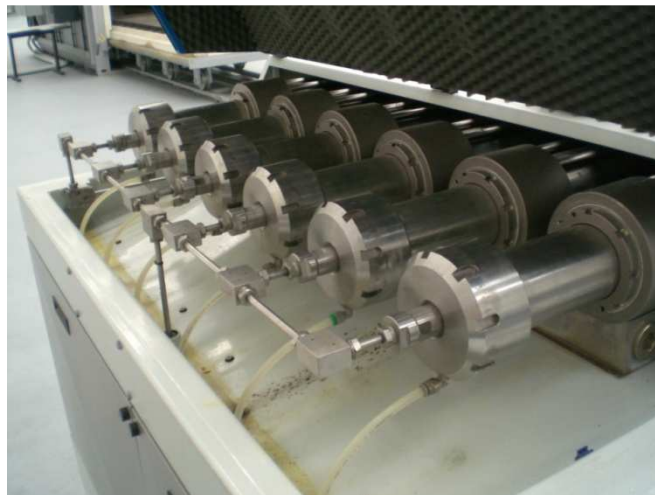
Figura 1. 5 Cilindri oleoidraulici che costituiscono l'intensificatore utilizzato
