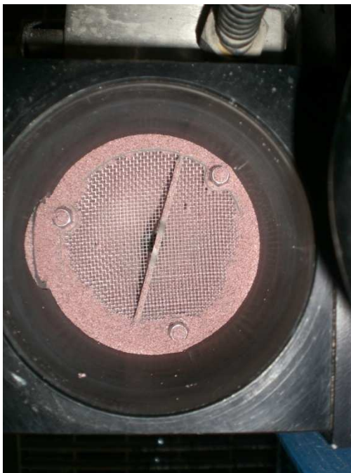
Figura A. 3 a) l'abrasivo lascia riaffiorare la maglia del setaccio: questo istante corrisponde allo stop nel cronometraggio; b) raccolta dell'abrasivo residuo in un contenitore, per procedere alla pesatura successiva.
