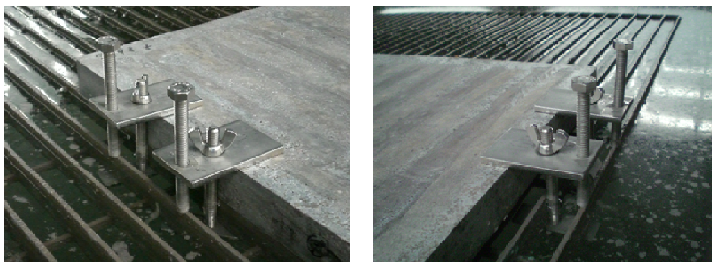
Figura 4. 7 Sistema di serraggio tramite morsetti per l'analisi dello spessore tagliabile
