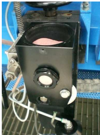
Figura 1. 9 Particolare della testa di taglio: tramoggia
