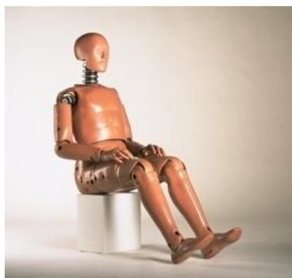
Figura A.0.2 - Hybrid III 50°percentile uomo
