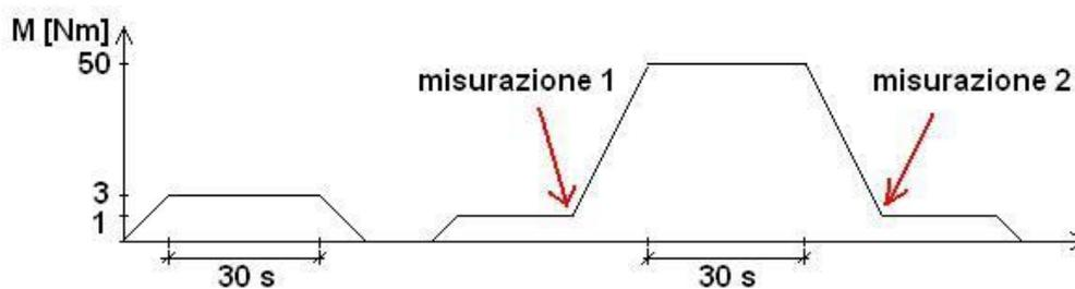
Figura 3.51 – Schema di applicazione dei carichi nella prova a torsione
