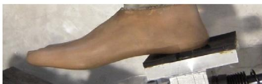
**Figura 4.20 – Particolare della spinta sul piede in configurazione modo I**
