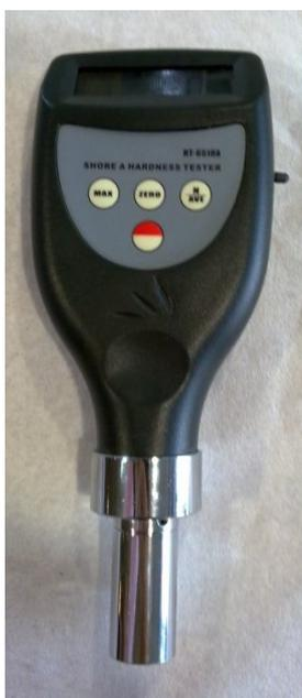
Figura 3.29 – Durometro digitale portatile HT-6510 A
