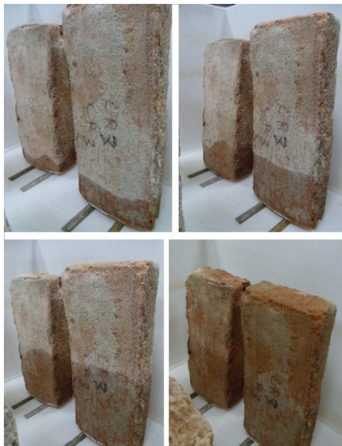
Illustrazione 2.9: Risalita capillare nei campioni CR1 e CR3.
