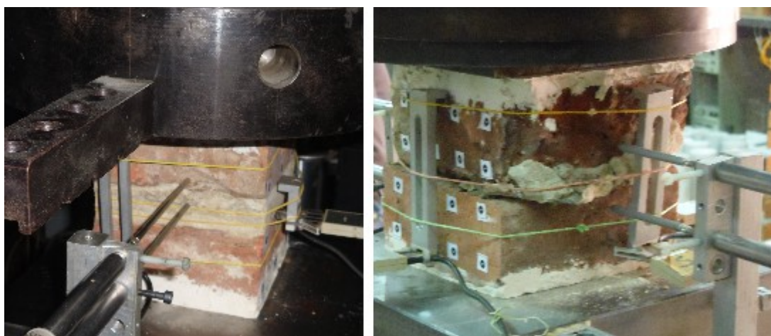
Illustrazione 3.25: Posizionamento dei trasduttori.
