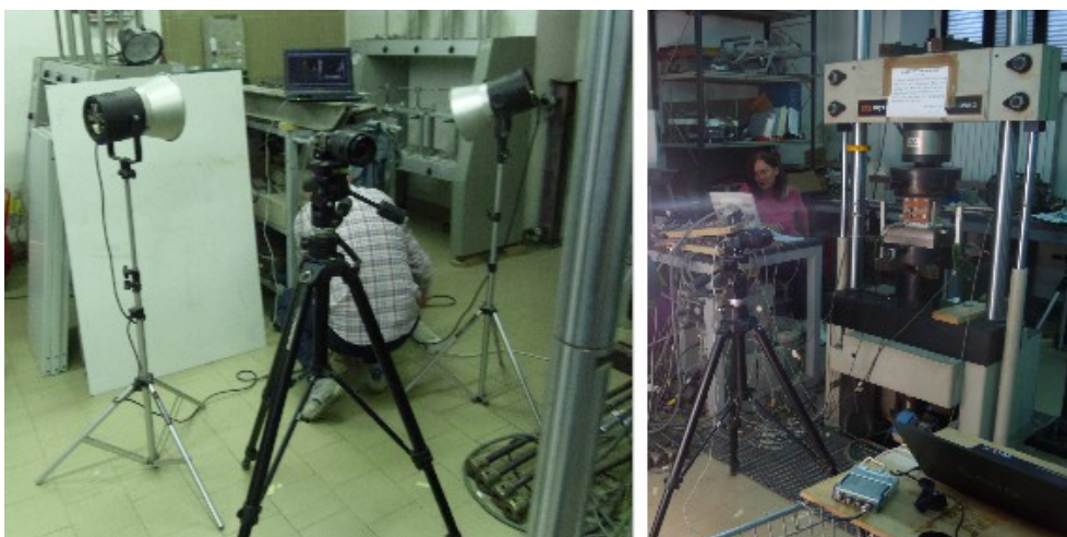
Illustrazione 3.14: Fotocamera e apparati di regolazione della luce per l'acquisizione ottica.
