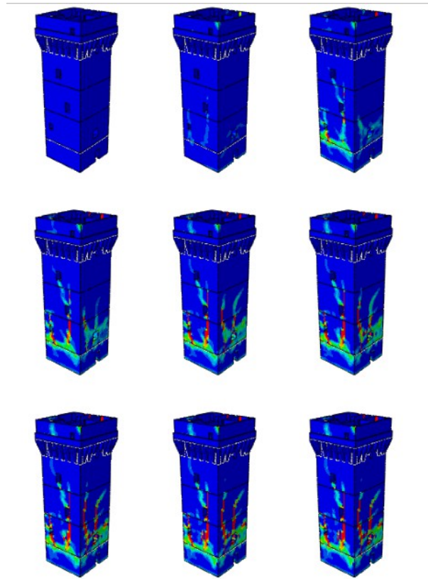
Illustrazione 9.5: Vista tridimensionale della struttura. Danno a trazione.
