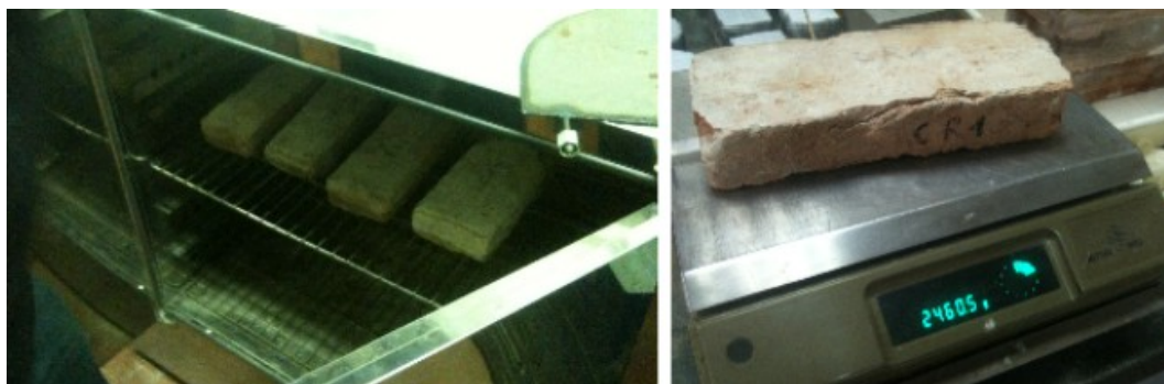
Illustrazione 2.4: Essiccazione e pesata dei mattoni.
