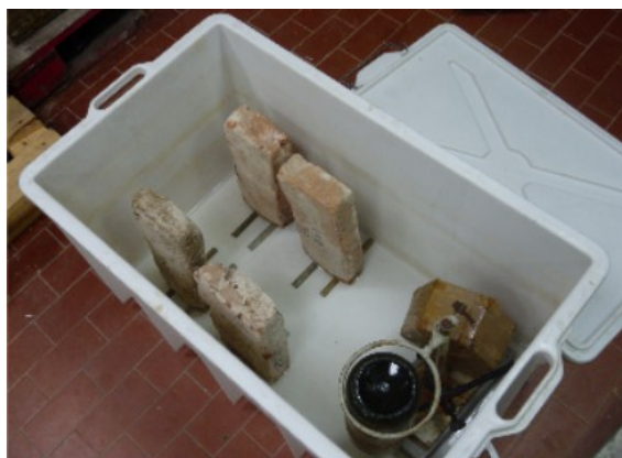
Illustrazione 2.8: Strumentazione per la prova di Risalita Capillare.
