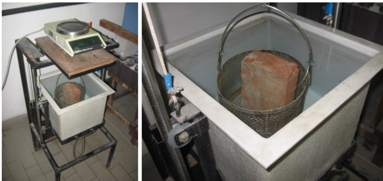
Illustrazione 2.12: Strumentazione per la pesata idrostatica.
