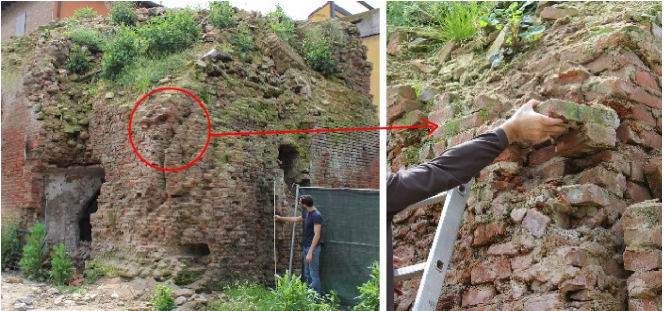
Illustrazione 1.10: Prelievo del campione TOB7C
