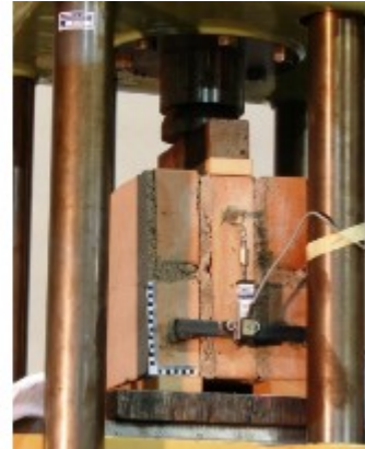
Illustrazione B.11: Prova sperimentale di scorrimento.
