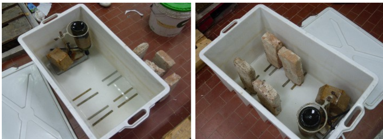
Illustrazione 2.1: Strumentazione per le prove di risalita capillare.
