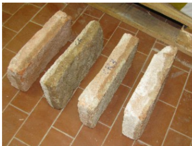
Illustrazione 2.7: Campioni al termine della prova I.R.S..
