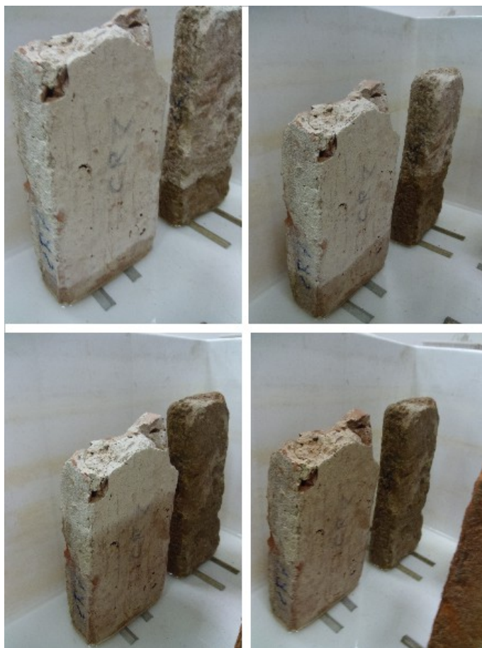
Illustrazione 2.10: Risalita capillare ne campioni CR7 e CR2.
