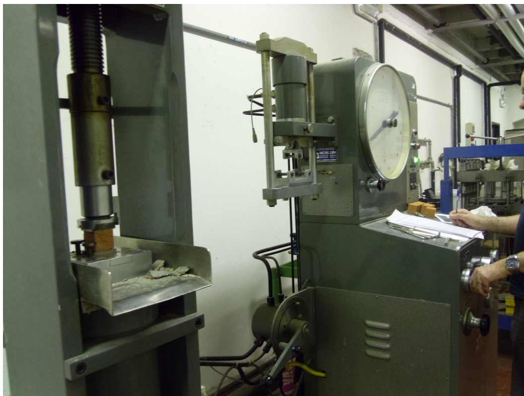
Illustrazione 2.18: Strumentazione per la prova a Compressione.
