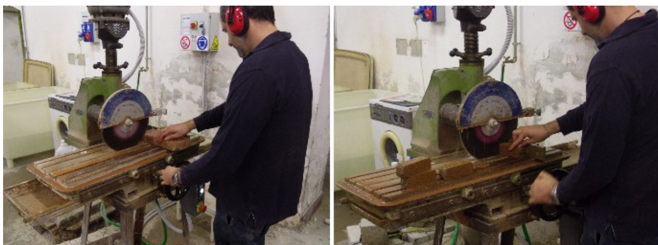
Illustrazione 2.15: Processo di taglio dei mattoni.
