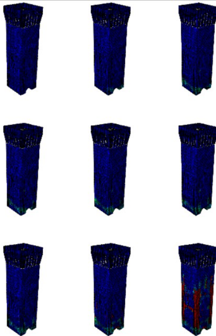
Illustrazione 9.28: Vista tridimensionale del Mastio. Danno a trazione.
