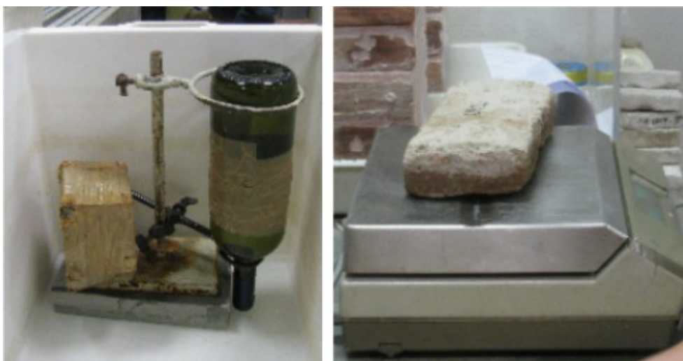
Illustrazione 2.6: Strumentazione per la prova I.R.S..
