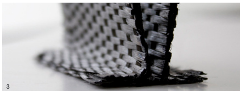
Fig.3_Biteam, tessuti multilayer con sezioni trasversali complesse per il rinforzo di compositi
