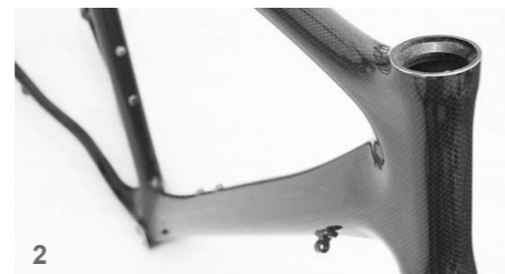
Fig.1-2 _Hasa, telaio full frame in fibra di carbonio con inserti
