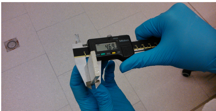
[60] Misurazione dello spessore di un provino mediante calibro a seguito dell'applicazione del coating.
