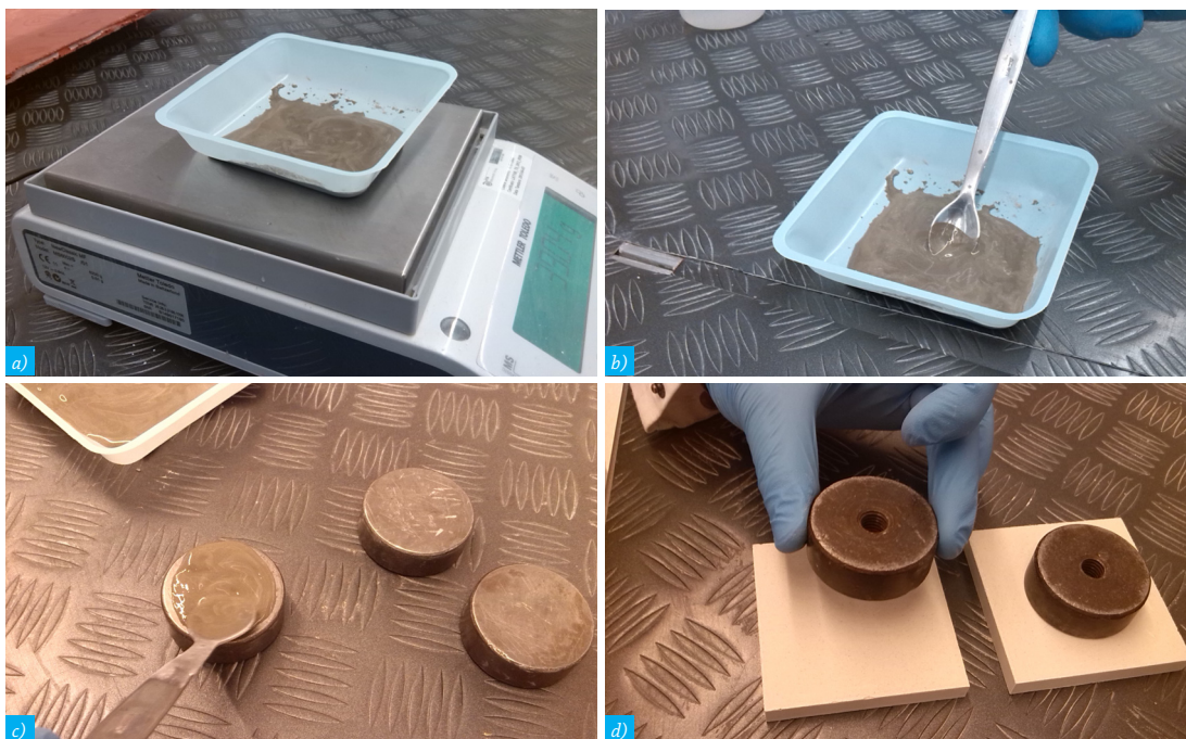
[63] Preparazione dei provini: a) Dosaggio dell'adesivo bicomponente; b) Miscelazione dell'adesivo; c) Applicazione dell'adesivo sulla testina; d) Centraggio della testina sul provino.
