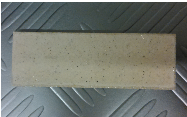
[81] Esempio di provino utilizzato per la prova di resistenza al microonde.
