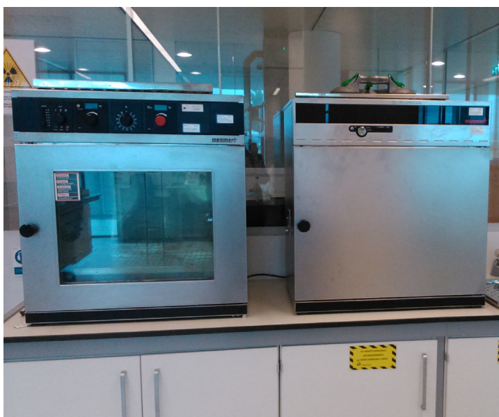
[75] Forno di prova impostato a 100°C e incubatore impostato a 5°C con all'interno una soluzione di acqua e rodamina(5%).
