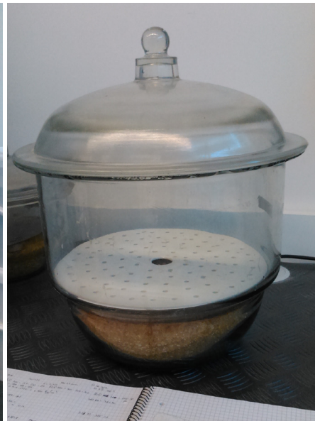
[66] Essiccatoio con camera a vuoto.
