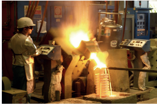
Figura 1.2.4: Riempimento dello stampo ceramico con acciaio liquido
