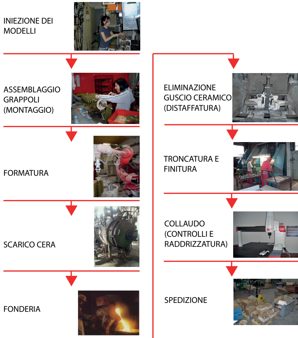
Figura 1.2.1: Schematizzazione del processo Microcast
