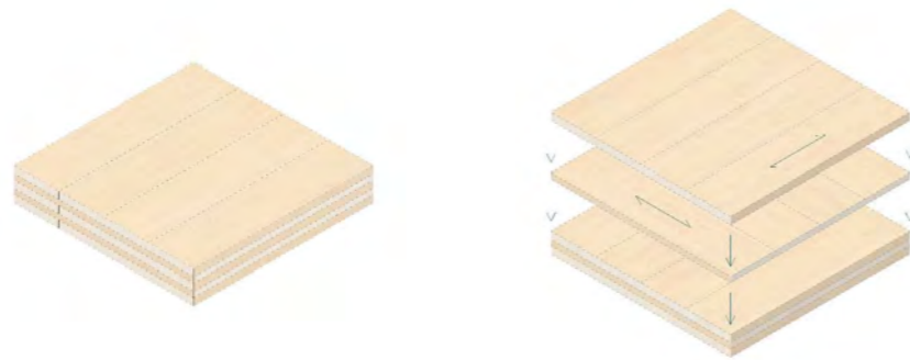
Figura 19.02: Pannello in CLT. Fonte: Autori.
