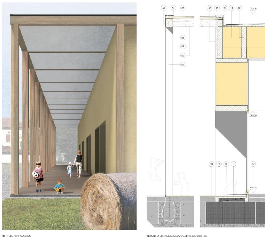
Figura 2.22: Dettaglio portico in legno con stratigrafia annessa
