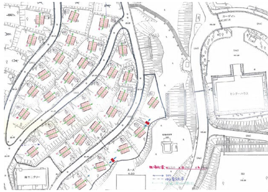
Figura 12 - Schema planimetrico dove viene sottolineata l'inclinazione dei moduli secondo un asse.
