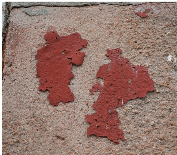
Fig. 49 - Venezia. Luglio 2020. Degrado di una pittura. Evidenti differenze cromatiche e di degrado con il substrato.
