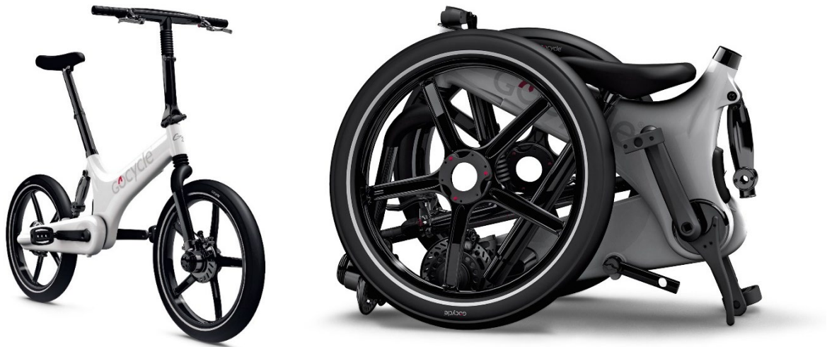
Figura 1.5: E-bike per uso urbano GoCycle 2 realizzata dalla casa produttrice Karbon Kinetics Ltd, premiata vincitrice ai Red Dot Awards 2015. Diverse parti che costituiscono il frame dell'e-bike sono realizzate in leghe di magnesio [38] [39].
