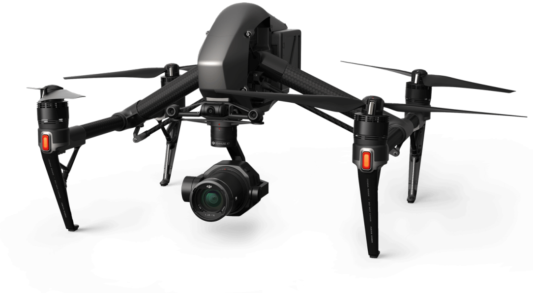
Figura 1.3: Drone Inspire 2 realizzato dalla società cinese DJI per la produzione di riprese cinematografiche professionali. Gli elementi della scocca sono realizzati in lega di magnesio [30].
