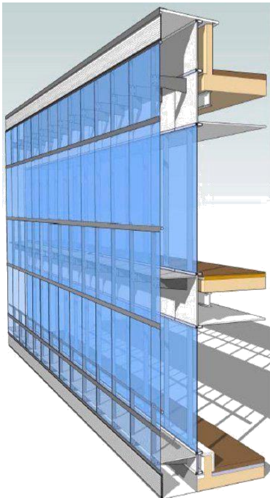
Figura 1.4 - Facciata ispezionabile con pelle esterna chiusa
