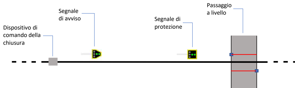
Figura 4.14: Schema del segnalamento e degli enti
