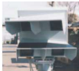
Figura 4.10: Esempio di una videocamera stereoscopica per PL [11]
