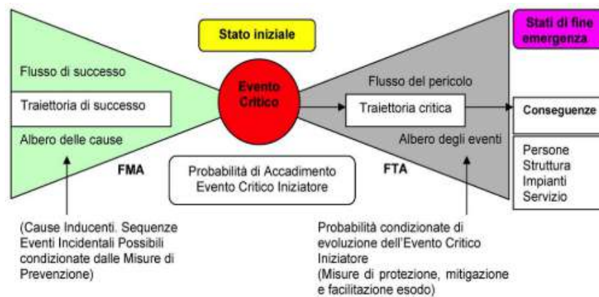
Figura 6.18: Schema generale di un diagramma BowTie [17]
