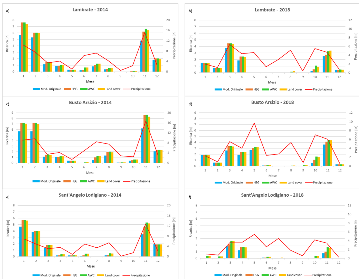
Figura 57: Valori di ricarica meteorica ottenuti aggiornando progressivamente il file HSG, il file AWC e quello relativo a Land cover per gli anni 2014 (a, c, e) e 2018 (b, d, f)
