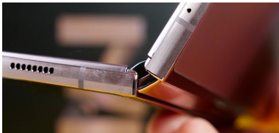
Particolare della cerniera del Galaxy Z fold 2 di Samsung
