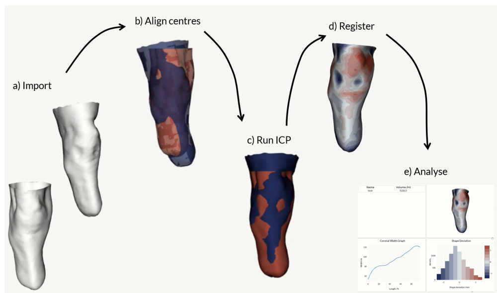
Figura 3.25: Flusso dei processi gestiti da AmpScan. [39]
