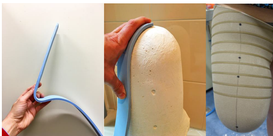
Figura 2.9: Striscia in pelite: permette di tracciare linee sulla cuffia tra due punti di reperi e successivamente di identificarne ulteriori lungo i percorsi tracciati.
