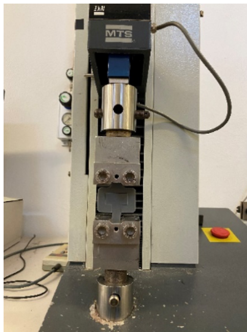
Figura 3.12: Primo prototipo di afferraggi in resina Grey Pro all'interno del banco di prova per test a trazione.
