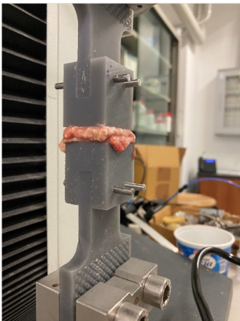
Figura 3.18: Afferraggi polimerici inseriti all'interno del set-up sperimentale, vista latero-frontale (a sinistra), vista laterale (a destra).
