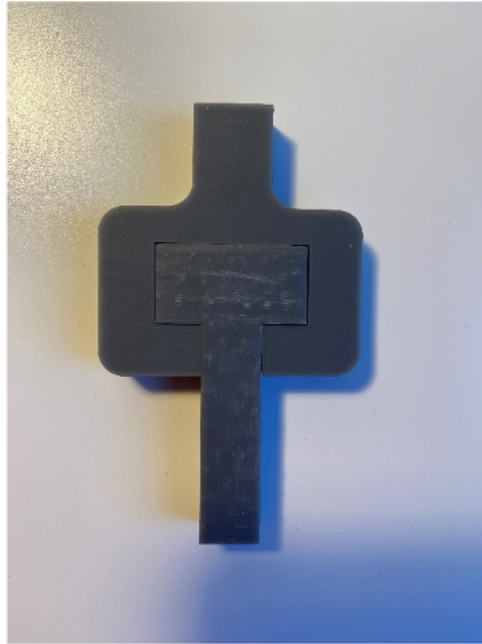
Figura 3.10: Primo prototipo di afferraggi in resina Grey Pro.
