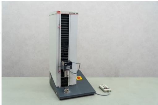
Figura 3.7: MTS Synergie 200H (a sinistra), software collegato alla macchina (a destra).
