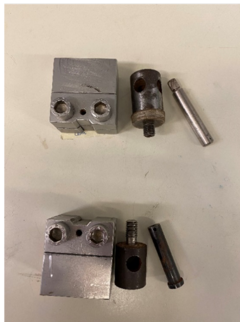
Figura 3.8: Afferraggi in acciaio specifici della MTS Synergie 200H.
