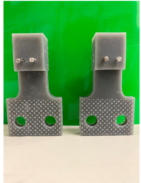
Figura 3.17: Provini polimerici per test di trazione monoassiale assemblati dopo la stampa in 3D con resina Grey Pro. Vista superiore (a sinistra), vista frontale (a destra).
