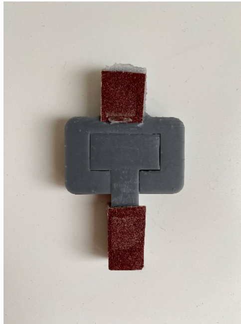
Figura 3.11: Primo prototipo di afferraggi in resina Grey Pro ricoperti di carta abrasiva.
