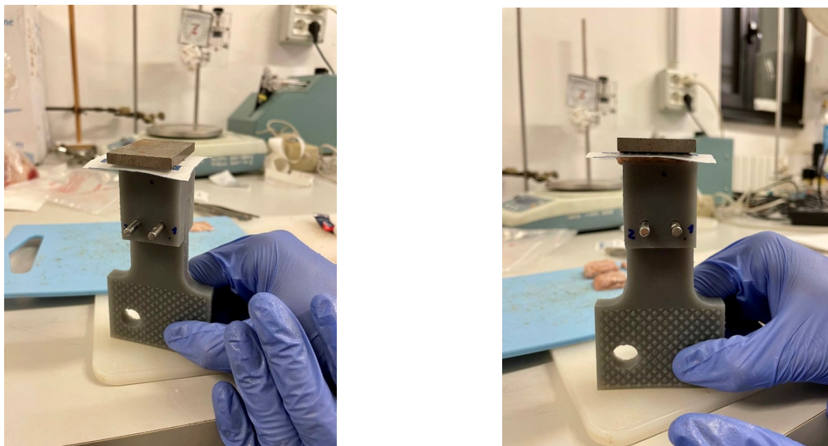
Figura 3.6: Vista latero-frontale (a sinistra) e frontale (a destra) del campione biologico durante l'incollaggio al supporto polimerico. Sono visibili dal basso verso l'alto rispettivamente: pancreas, Parafilm e peso.
