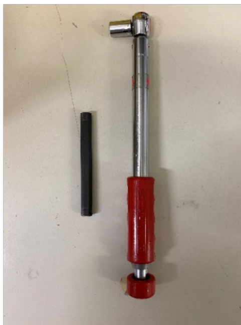
Figura 3.14: Brugola esagonale e chiave dinamometrica per l'applicazione della corretta coppia di serraggio durante i test.
