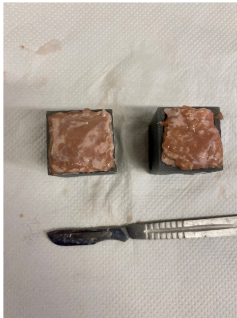
Figura 3.5: Campioni biologici disposti sullo strato di colla a base di cianoacrilato.
