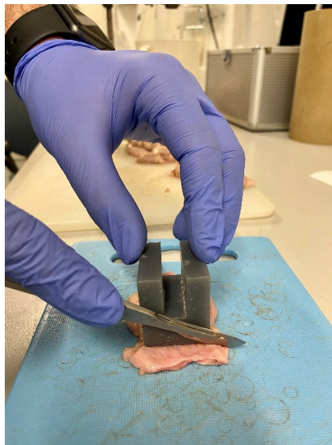
Figura 3.3: Guida per il taglio del campione tramite bisturi.
