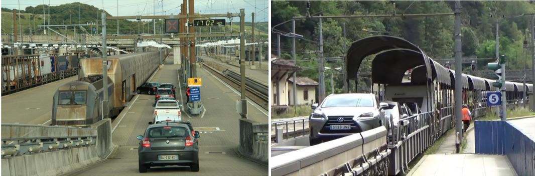
(a) Eurotunnel Shuttle tra Calais e Folkestone. (b) Treno navetta operato dalle Ferrovie Federali Svizzere presso la stazione di Iselle.
