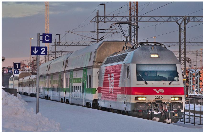
Figura 1.16: Treno intercity operato dalla compagnia nazionale finlandese (VR). Si notino le differenze di dimensioni tra le carrozze *double deck* e il resto del convoglio (Fonte: happyrail.com).
