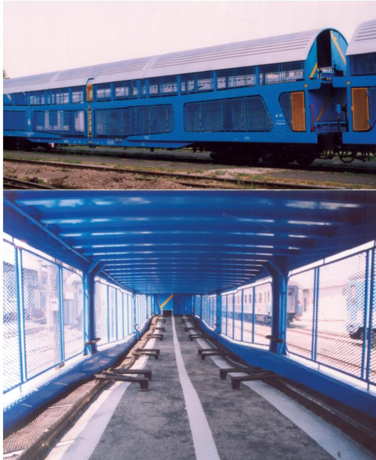
Figura 1.14: Carro tipo MDDlm (*TŽV Gredeľj ltd.*).
