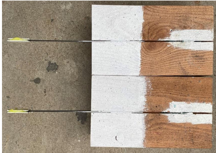
Figura 7.7 – 2 provini del blocco DS_C_30 ultimati. Da notare le placche in vetroresina all'estremità delle lamine in CFRP e la verniciatura bianca con relativo speckle pattern
