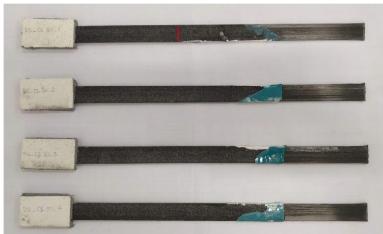
Figura 6.9 - Modalità di rottura per la serie di provini DS_CS_30 [11]
