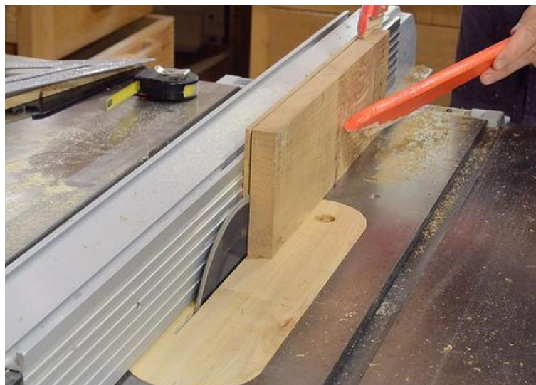
Figura 6.6 - Fresatura di una tavola in legno con banco sega [11]
