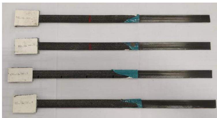
Figura 6.12 - Modalità di rottura per la serie di provini DC_CS_100 [11]
