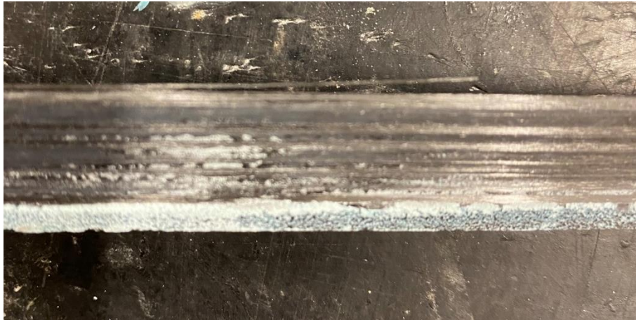
Figura 8.9 - Lesione della lamina in carbonio del provino DS_C_100_4
