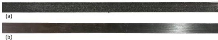
Figura 4.6 - Barre a sezione rettangolare in CFRP: sabbiate (a) e lisce (b) [11]
