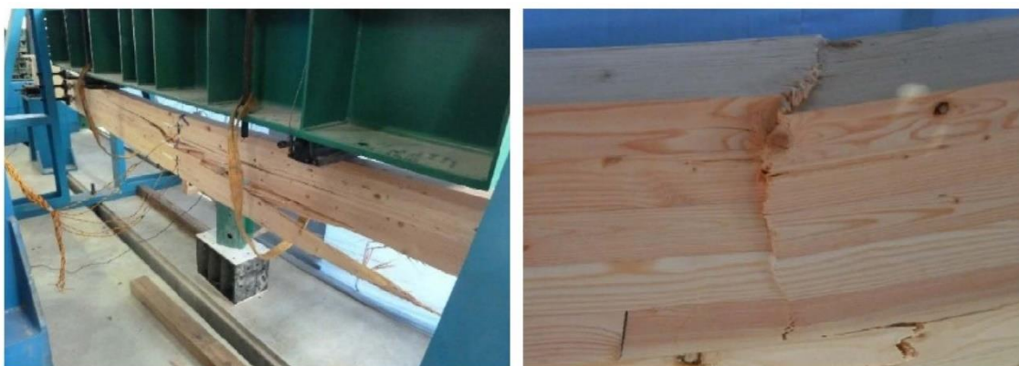
Figura 5.11 - Modalità di rottura di una trave non rinforzata e di rinforzata con collasso nella zona compressa [40]
