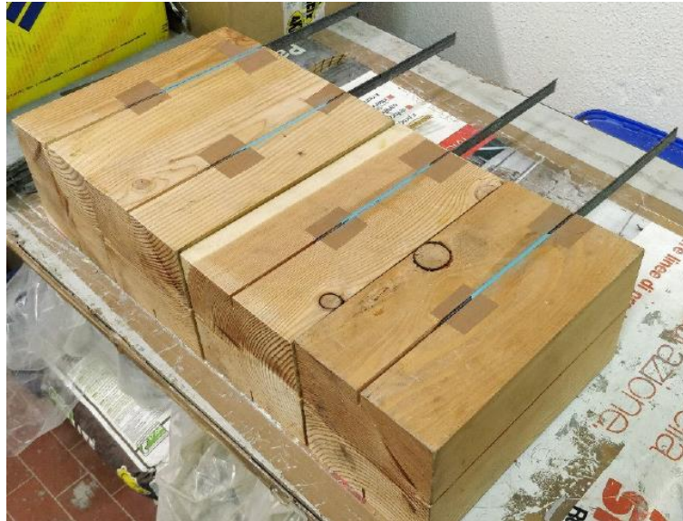
Figura 6.7 - Incollaggio delle lamine ai blocchi in legno [11]
