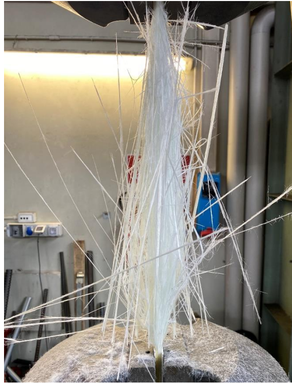
Figura 4.9 - Rottura di un profilo in GFRP (Prova eseguita presso il laboratorio prove materiali del Politecnico di Milano)
