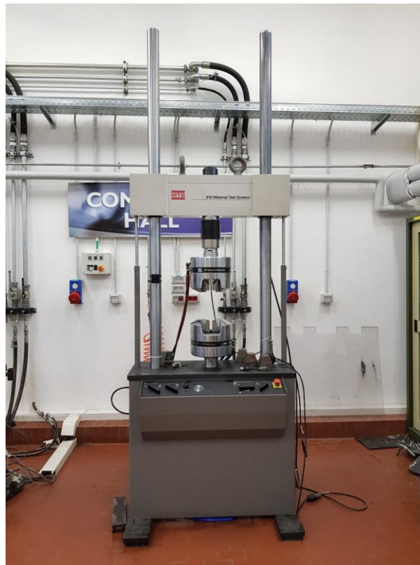
Figura 7.10 - Macchina di prova servoidraulica MTS con cella di carico da 250 kN [54]
