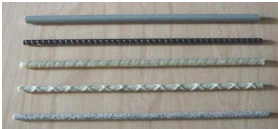
Figura 4.5 - Differenti tipologie superficiale delle barre in FRP. Dall'alto al basso si trovano barre: lisce, elicoidali, dentate, intrecciate e sabbiate [30]
