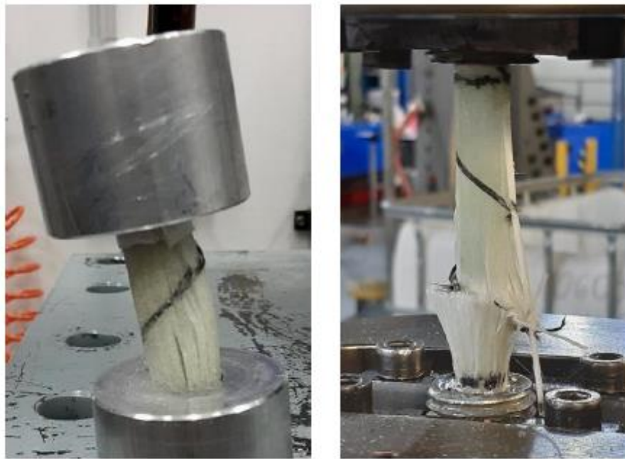
Figura 4.11 - Modalità di rottura a compressione di una barra in FRP [11]
