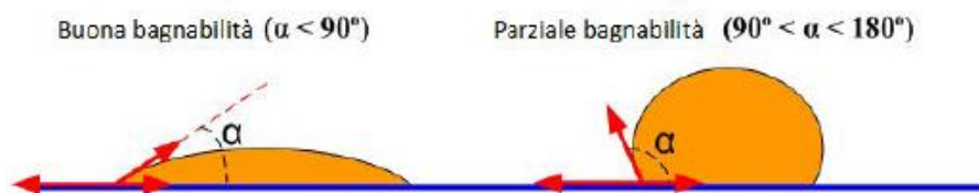
Figura 5.16 - Bagnabilità dell'adesivo in funzione dell'angolo di contatto [43]
