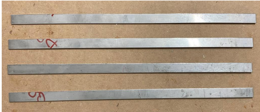
Figura 9.3 - Differenza tra le lamine in acciaio pulite e quelle non trattate
