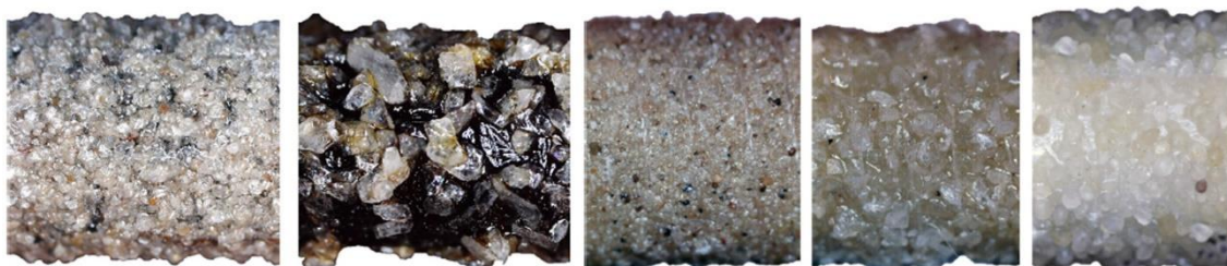
Figura 4.14 - Dettaglio di alcune barre non deformate superficialmente e sabbiate.
