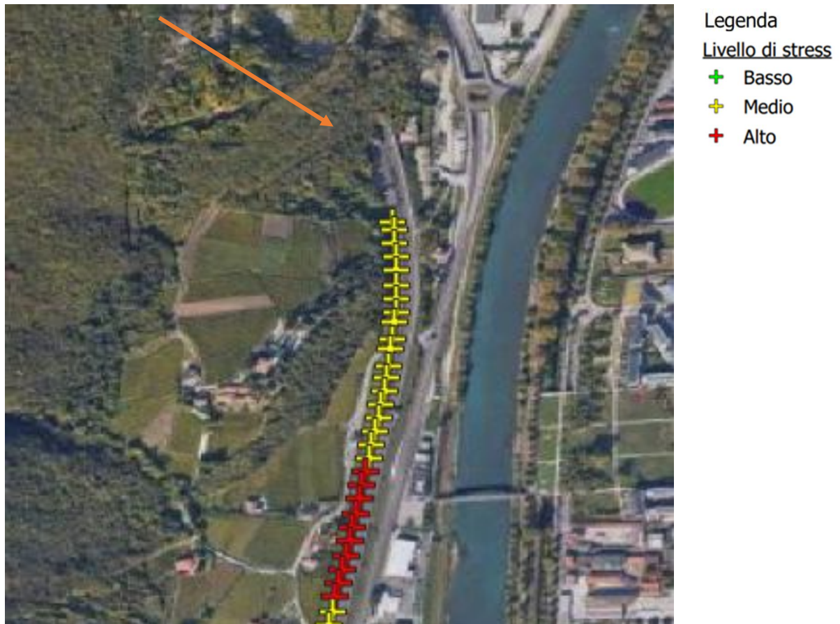
Figura 3.35 - veicolo Leader, picco di stress in corrispondenza della disaggregazione del platoon all'imbocco della galleria
