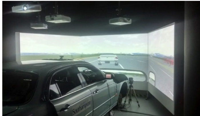
Figura 1.28 - Simulatore di guida dell'università di Southampton durante un esperimento [21]
