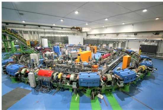
Figura 2. Vista della sala del sincrotrone del CNAO di Pavia. Questo acceleratore ha forma circolare, con diametro di 25 m e circonferenza di circa 80 m.
