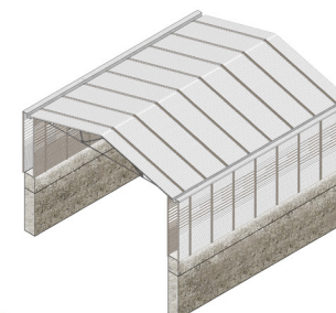
Copertura in lamiera
