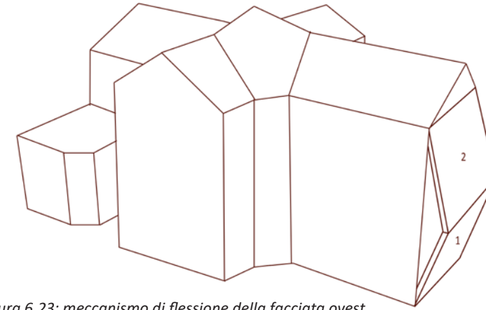
Figura 6.23: meccanismo di flessione della facciata ovest
