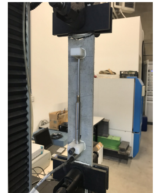
Figura 6.13: prova di trazione su un provino
