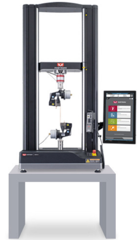
Figura 6.12: pressa elettro-meccanica INSTRON
