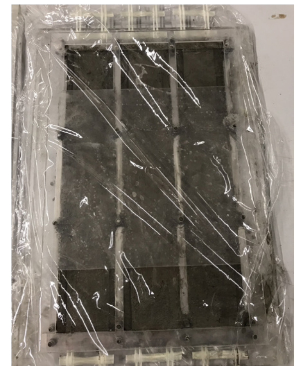
Figura 6.11: fase di getto terminata. Provini coperti con telo di cellofan
