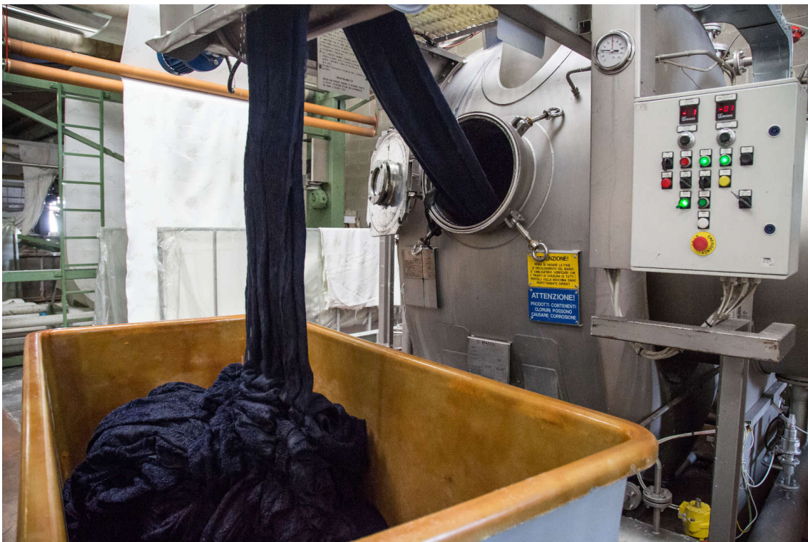
^ 23. Processo di tintura in overflow, Texcene (2024).
