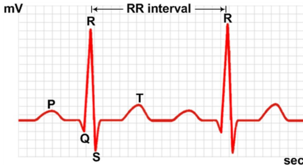
Figura 1.4: Illustrazione dell'intervallo R-R, delle onde P, T e del complesso QRS in un tracciato elettrocardiografico (ECG) [21].
