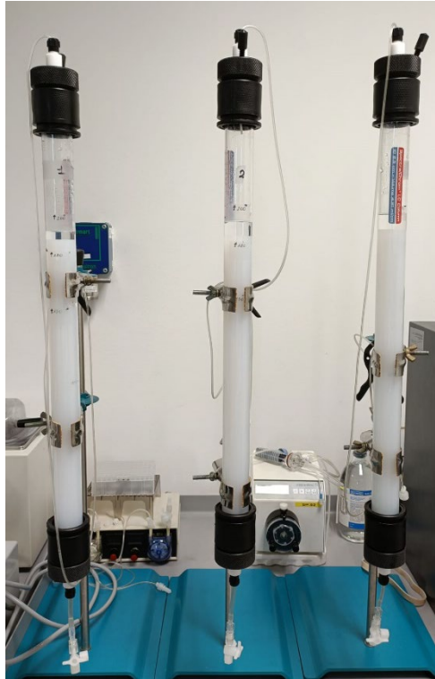
Figura 31: Sistema di estrazione del GFP: tre colonne riempite con gel di agarosio e tre pompe peristaltiche.
