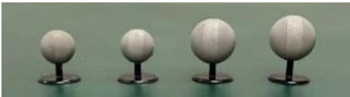
Figura 4: Marcatori utilizzati per le acquisizioni all'interno del laboratorio ( \varnothing= 10-15 mm).
