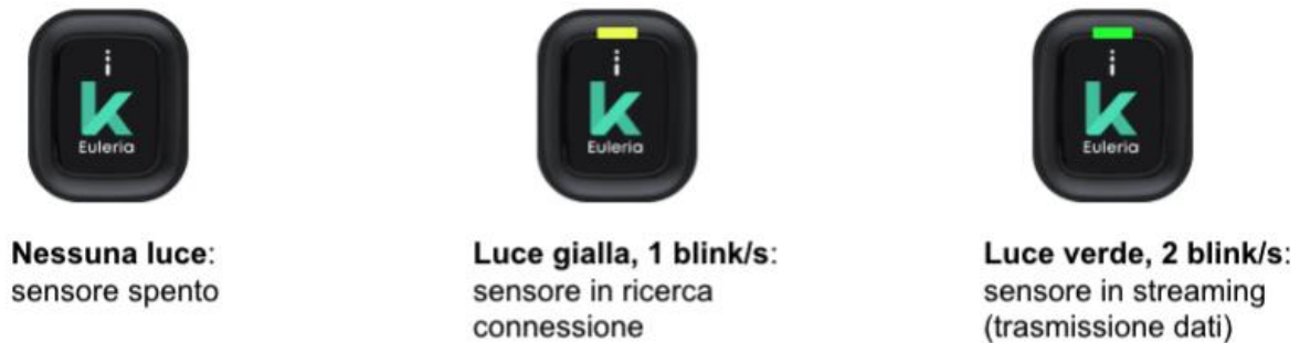
Figura 6: Luci del sensore e loro significato.
