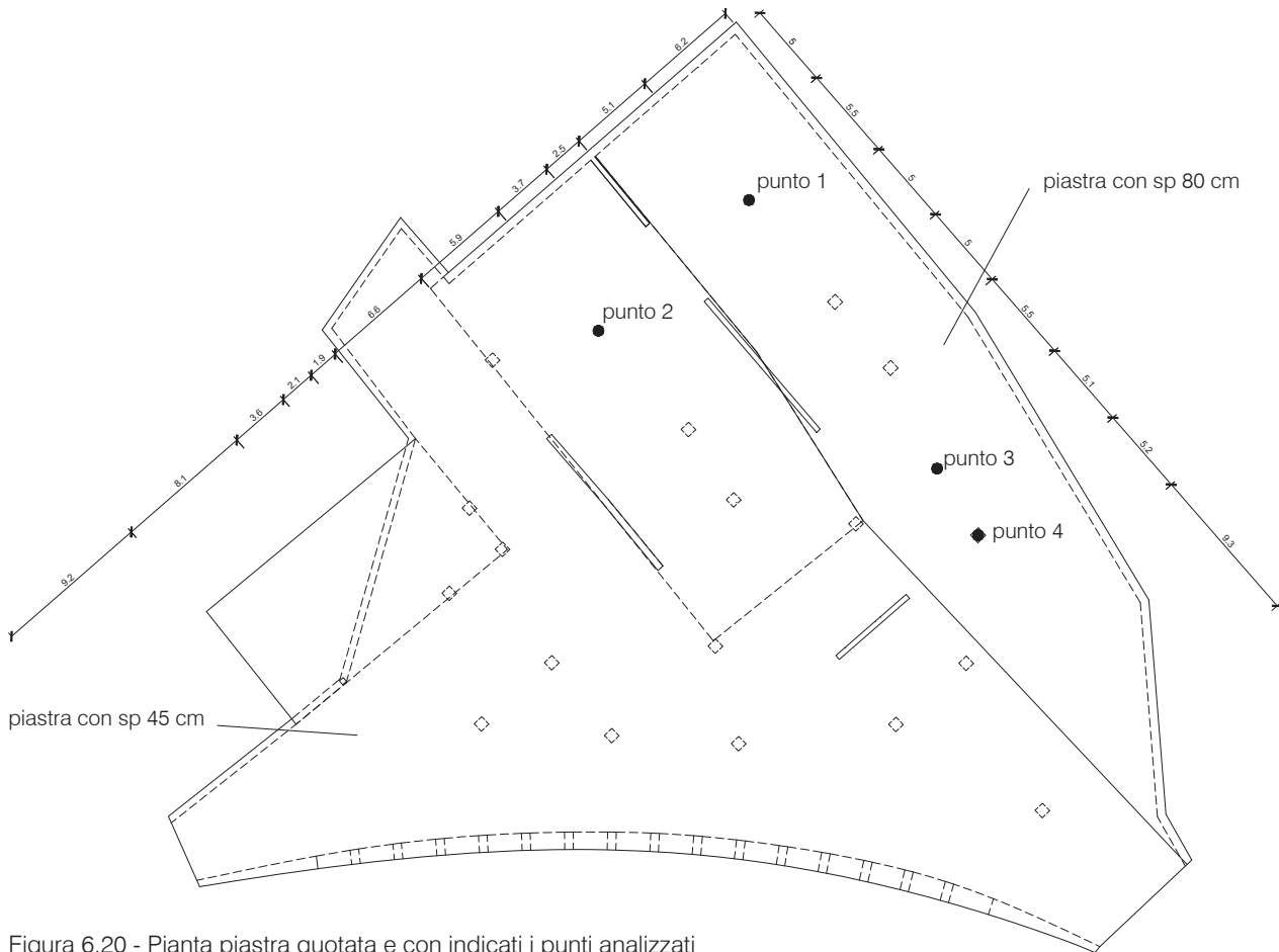
Figura 6.20 - Pianta piastra quotata e con indicati i punti analizzati
