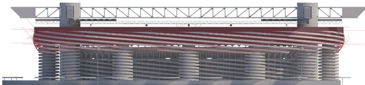
Fig. 16 - Terza fase: nuovi rivestimenti a spirale in lamiera stirata.
