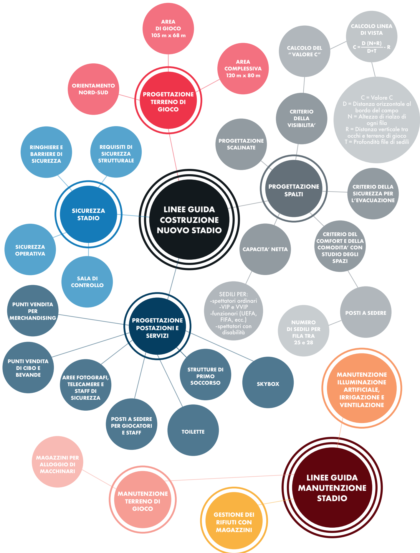
Grafico 16 - Mappa concettuale per la progettazione e la manutenzione di uno stadio. FONTE: Elaborazione personale su dati LINEE GUIDA STADIO UEFA.
