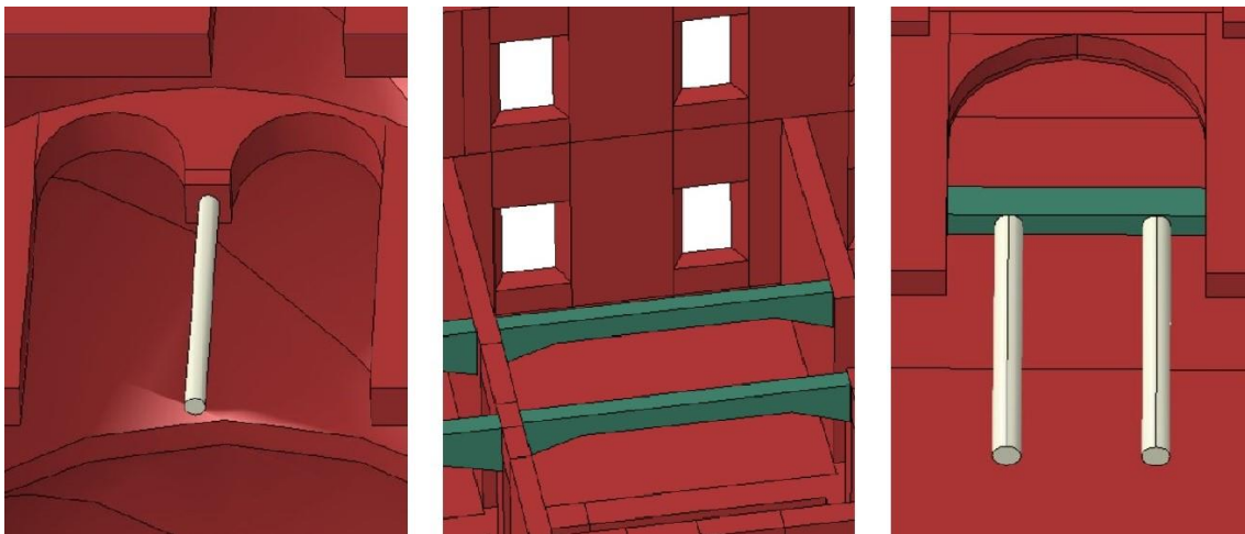
Figura 4.8: Diversificazione dei materiali nel modello 3D
