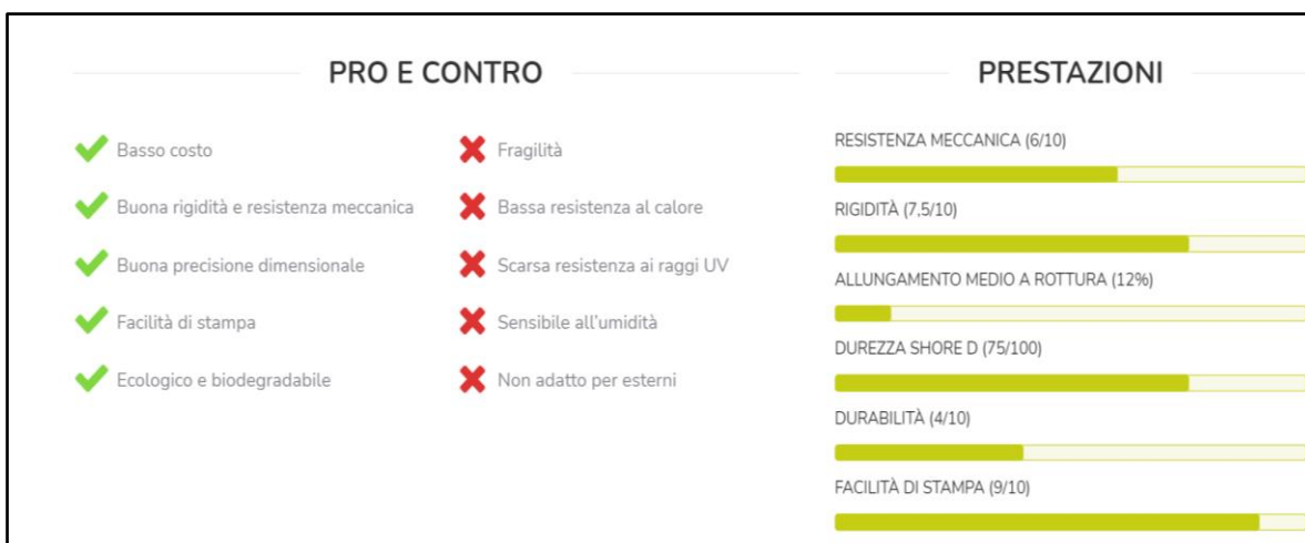
Figura 2.18 Riepilogo delle caratteristiche principali del materiale PLA
