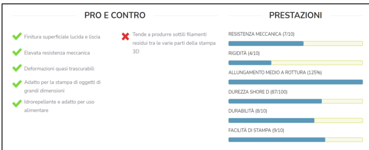
Figura 2.32 Riepilogo delle caratteristiche principali del materiale PET
