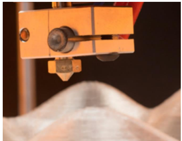
Figura 2.22 Fotografia della sonda induttiva contactless necessaria per la calibrazione automatica
