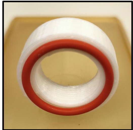
Figura 2.28 Immagine dell' Anello di fissaggio stampato
