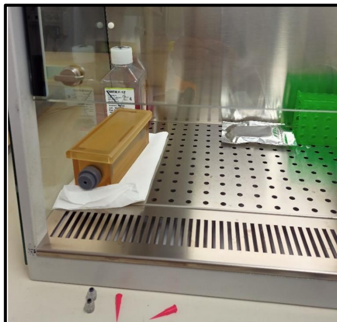
Figura 3.2 Collocamento della camera di coltura sotto cappa per il processo di sterilizzazione
