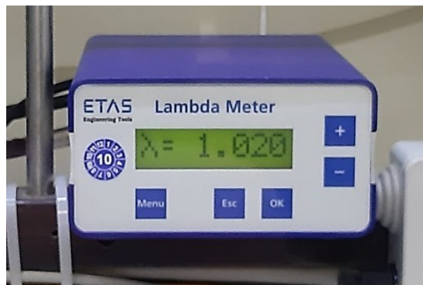
Figure 2. 14 – ETAS LA4 Lambda Meter
