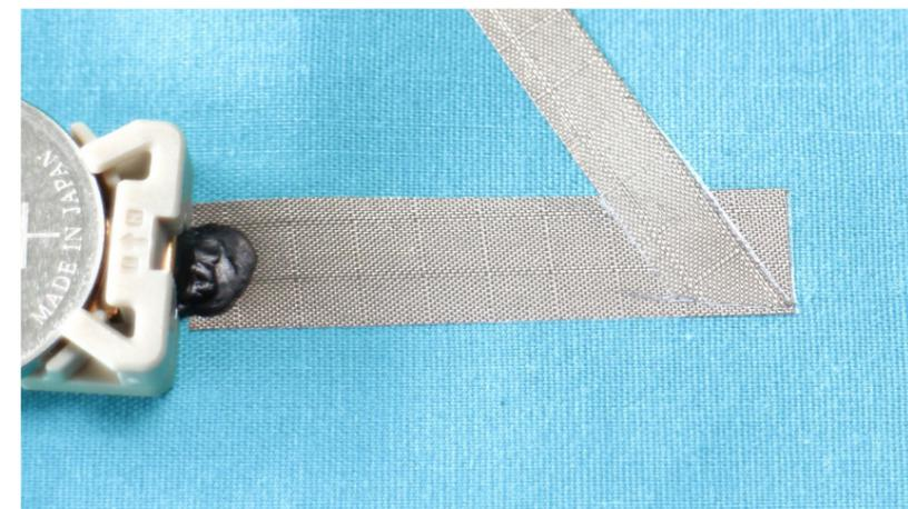
Fig. 45: esempio di connessione permanente tra tessuti conduttivi grazie all'utilizzo di colla conduttiva.
