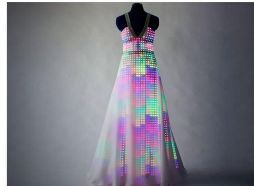
Fig. 38: esempio di come i tessuti conduttivi e gli e-textiles possono essere utilizzati nel settore della moda, per scopi puramente estetici. Ad esempio si possono cucire dei moduli led direttamente sul tessuto, creando capi di abbigliamento flessibili e luminosi.
