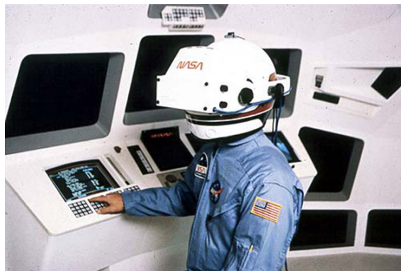
Fig. 2.8: Il sistema VIVED, creato dalla NASA
