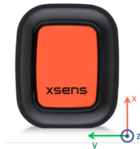
Figura 1.7 : IMU col suo sistema di assi di riferimento.
