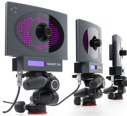
Figura 1.2 : Telecamere con illuminatori infrarossi integrati di un OS.
