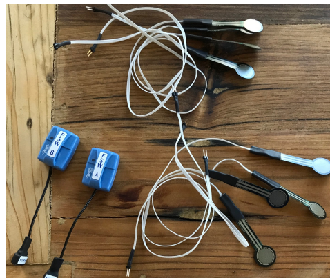
Figura 2.8. Sensori Footswitch ©Cometa S.r.l. (Italia).
