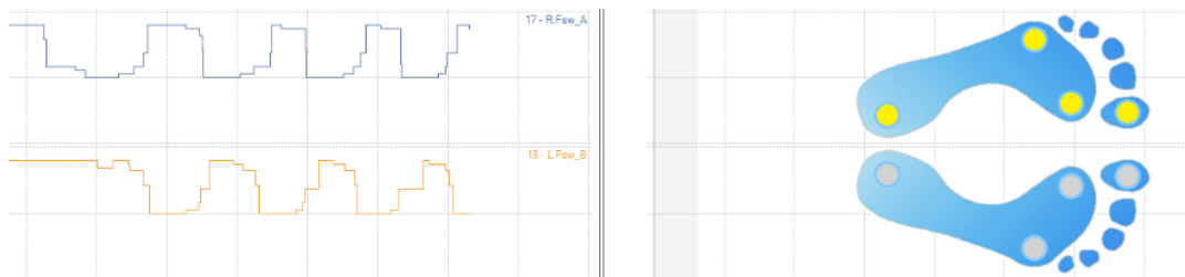
Figura 2.9. Segnale visualizzato durante l'utilizzo dei sensori Footswitch ©Cometa S.r.l (Italia).
