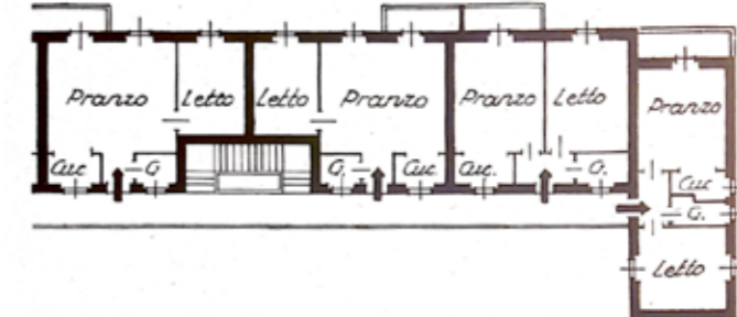
Fig. 85. - Piano tipo di fabbricato intensivo a ballatoio, con sei alloggi di 3 vani per ciascun piano.
