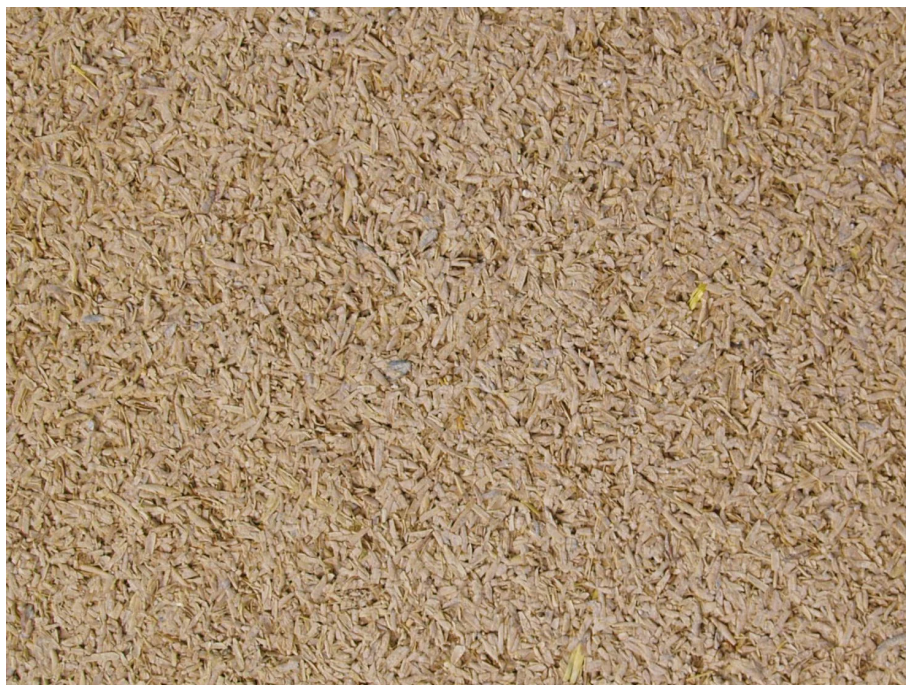
2.4: Pannello isolante termoacustico in lolla di riso e legante, Ricehouse
