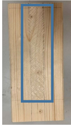
Figura 15 - Fresatura per l'aderenza migliorata
