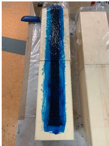
Figura 20 - Provino completo di resina e rinforzo in carbonio
