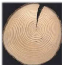
Fessurazione da ritiro
