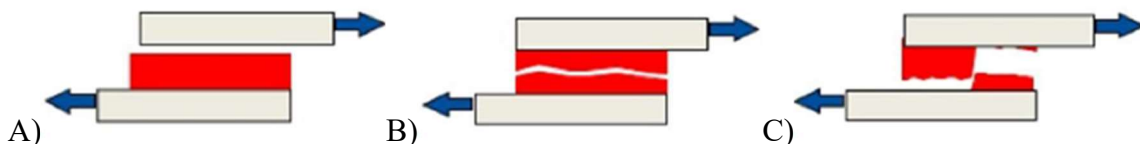
Figura 9 – A) rottura Adesiva; B) Rottura Coesiva; C) rottura mista
