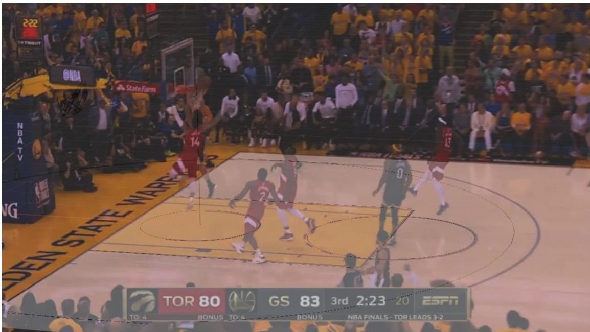
Figura 16: Calibrazione della telecamera. È possibile notare come le linee tratteggiate del campo virtuale si sovrappongano a quelle del campo reale.
