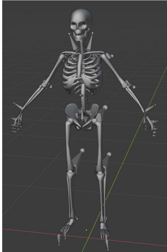
Figura 17: Modello scheletrico utilizzato nel presente lavoro. Su ogni articolazione è presente un elemento piramidale, attraverso il quale è possibile modificare l'orientazione delle stesse.
