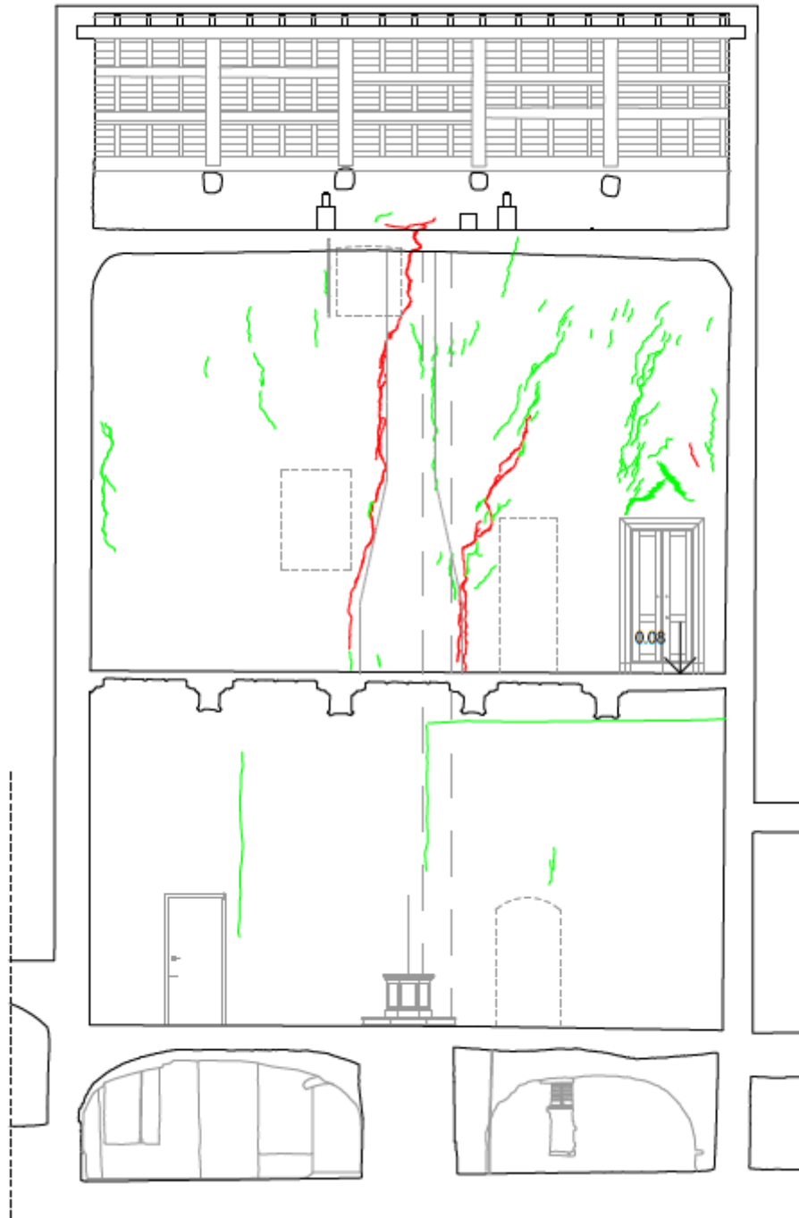
Figura 3-22: Quadro fessurativo - prospetto est
