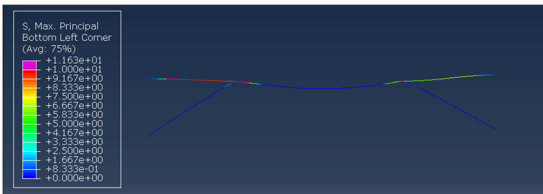
Figura 6-13: Sforzi principali massimi (catena 2) - Analisi elastica lineare con materiale ortotropo
