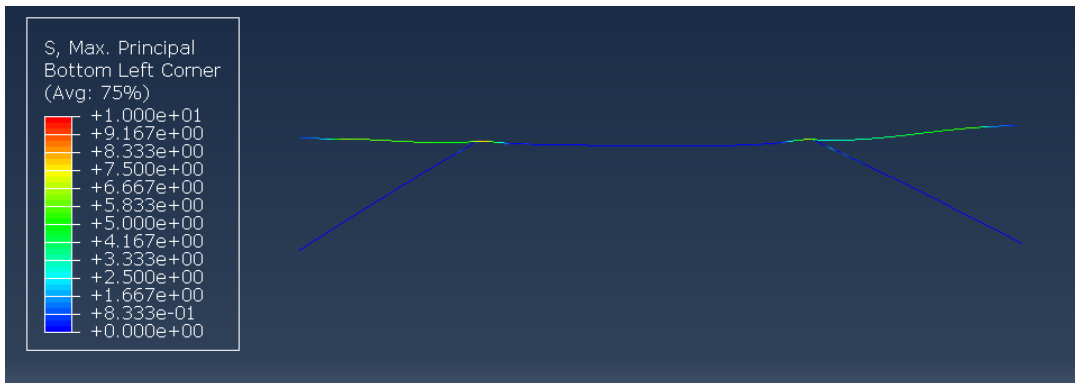
Figura 6-12: Sforzi principali massimi (catena 3) - Analisi elastica lineare con materiale ortotropo
