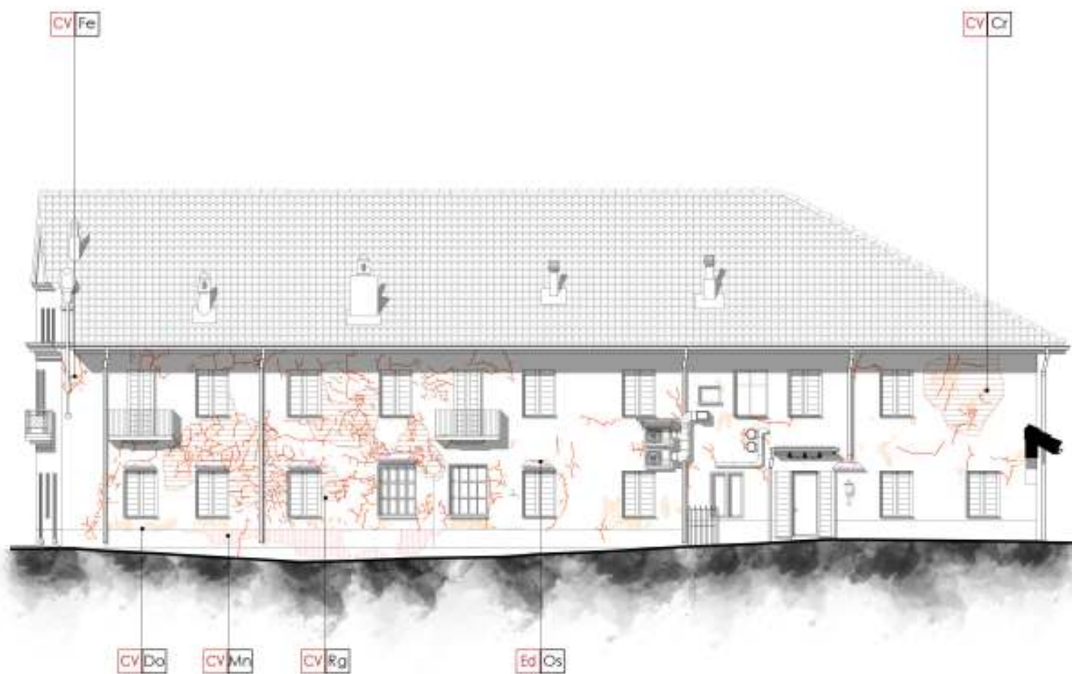
RILIEVO DEL DEGRADO VERTICALE EDIFICIO V NORD-EST, NORD-OVEST, SUD-EST, SUD-OVEST
